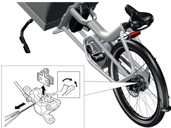
Bild 37: Ta bort bromsbeläggen för att kontrollera dem avseende slitage
