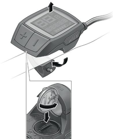
Immagine 30 : Sostituzione delle batterie del display Purion
