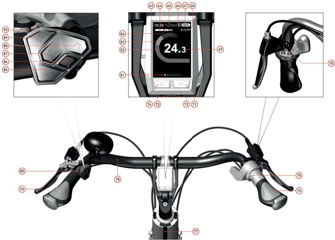
Immagine 3 : Manubrio con display Kiox e leva del cambio con indicatore di marcia
