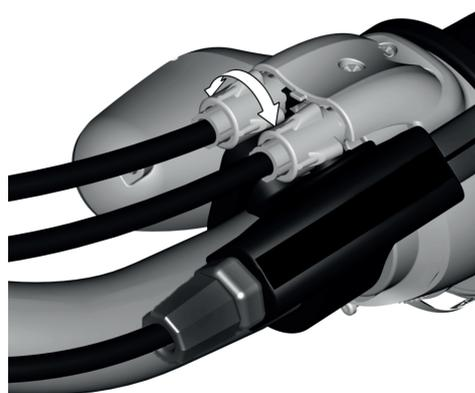
Billedet 39 : Reduktion eller forøgelse af kabelslæk ved at dreje cylinderen ved gribeskifteren
