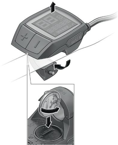
Kuva 30: Purion-näytön paristojen vaihtaminen
