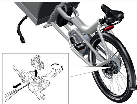
Bilde 37: Fjerning av bremseklossene for å sjekke dem for slitasje
