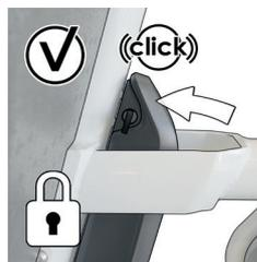
Immagine 18 : Esempio di batteria inserita correttamente
