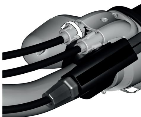
Immagine 39 : Riduzione o aumento dell'allentamento del cavo ruotando il tamburo sul cambio a manopola.
