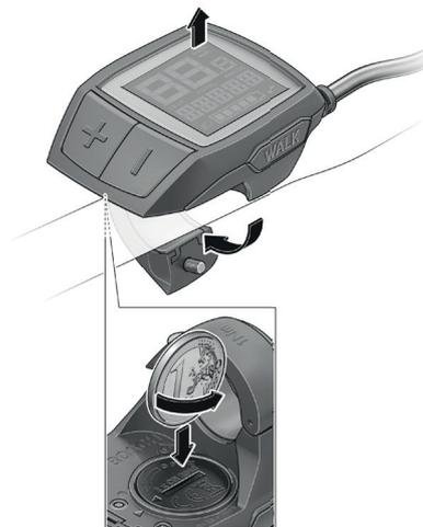
Bild 30 : Byta batterier på Purion-displayen
