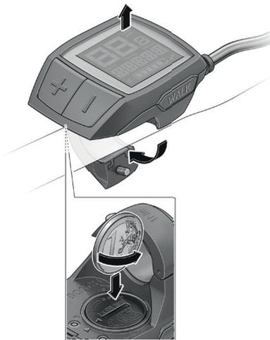
Bilde 30: Bytting av batteriene i Purion-displayet
