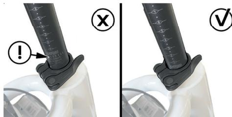
Bild 7 : Fjädrande sadelstolpe - min. insättning för sadelstolpen
