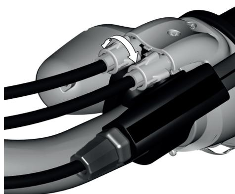
Imagen 39 : Cómo reducir o aumentar la holgura del cable girando el tensor en la palanca de cambios
