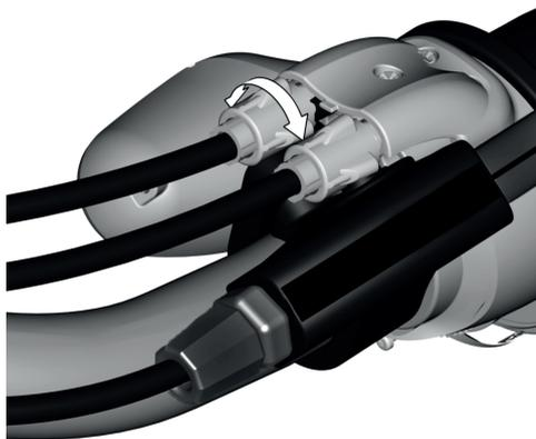
Bild 39 : Minska eller öka vajerlacket genom att vrida justeraren vid växelreglaget
