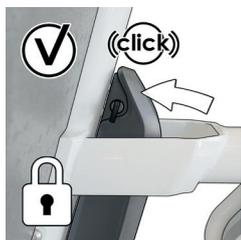
Imagem 18 : Som indicador de bateria bem colocada
