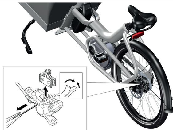
Imagem 37 : Remoção das pastilhas de travão para verificar se apresentam desgaste
