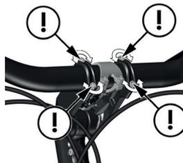
Bild 9B: Vrid på styrets vinkelskruvar
