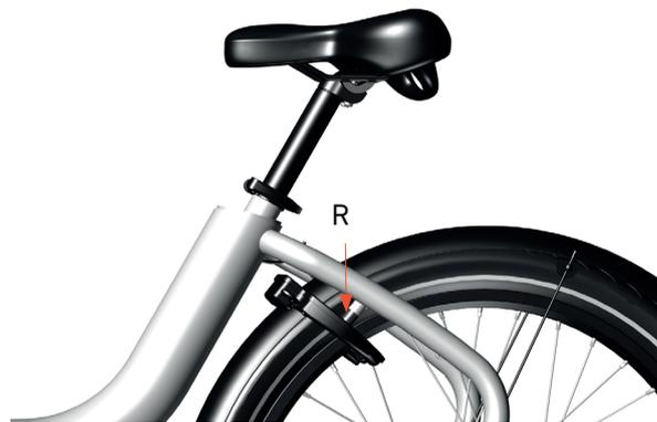
Immagine 36 : Controllo delle guarnizioni della serratura
