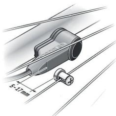
Bilde 31: Avstand mellom fartssensoren og fartssensormagneten
