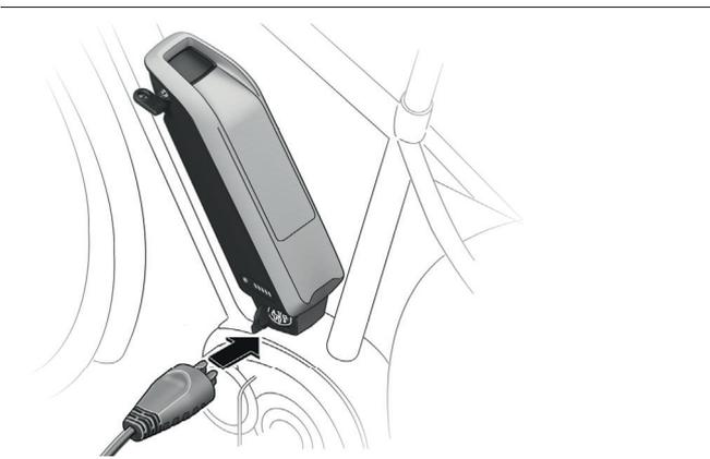
Bilde 28: Tilkobling av ladepluggen i strømkontakten på den nedre delen av batteriholderen
