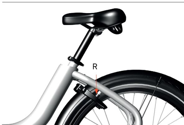
Bild 36 : Kontrollera gummihållarna
