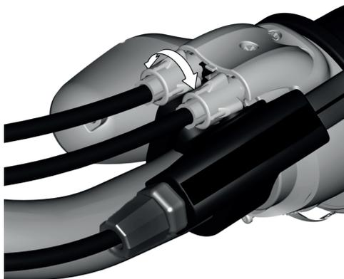
Bilde 39: Øking eller redusering av kabelslakk ved å rotere på hylsen ved girskifteren
