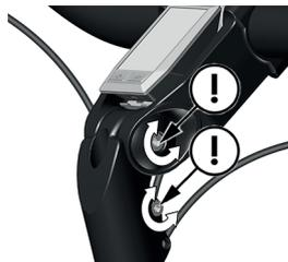
Bild 9 A: Vrid på styrstammens vinkelskruvar
