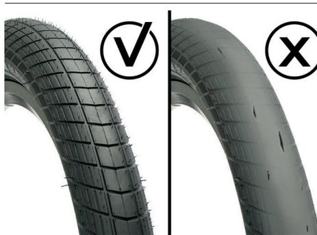
Imagen 32 : Desgaste de los neumáticos
