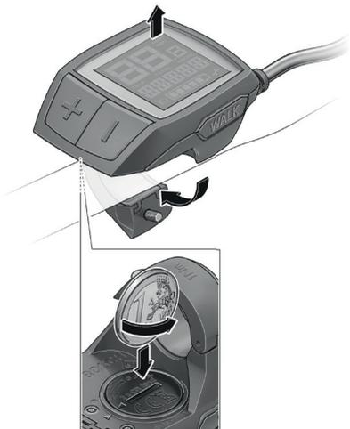
Imagem 30 : Substituir as pilhas do visor Purion
