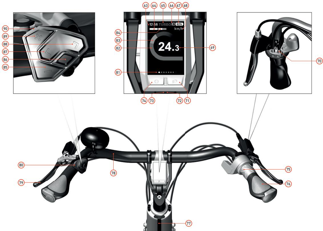
Bilde 3 : Styre med Kiox-display og girskifter med girindikator
