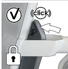
Imagen 18 : Reacción batería montada correctamente
