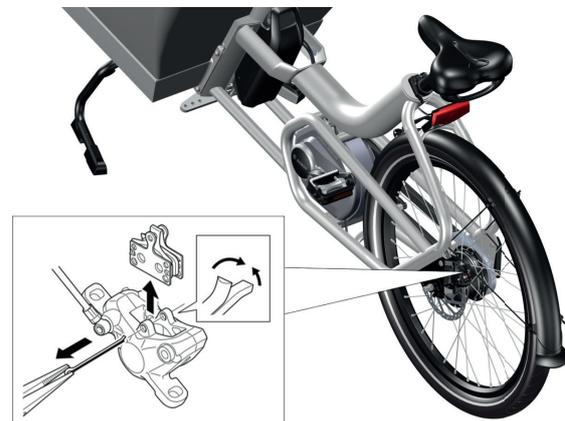
Billedet 37 : Afmontering af bremseklodser for at tjekke dem for slitage
