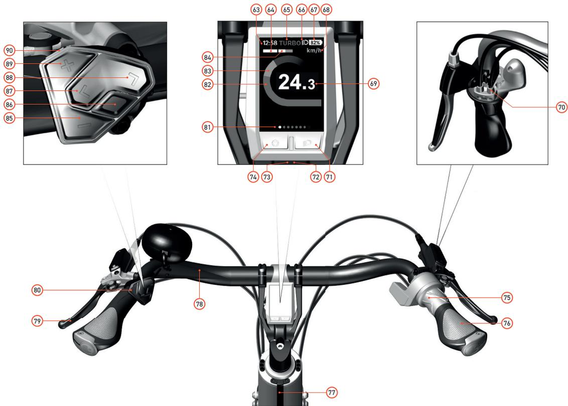
Bild 3 : Styre med Kiox-display och växelreglage med växelindikator
