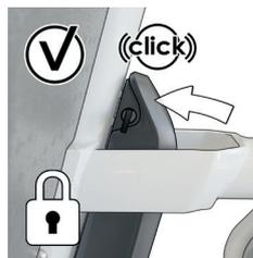
Bild 18: Klickljud när batteriet sätts i korrekt
