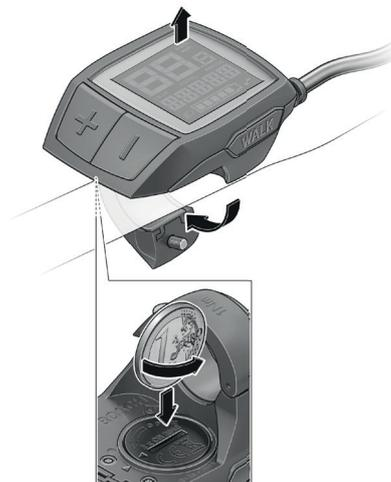
Imagen 30 : Cómo cambiar las pilas de la pantalla Purion
