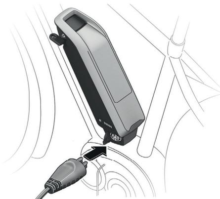
Imagen 28 : Cómo conectar el enchufe del cargador en el zócalo de carga en la parte inferior del soporte de la batería
