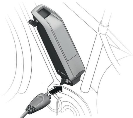
Immagine 28 : Inserimento della spina del caricabatterie nella presa di ricarica sulla parte inferiore del supporto batteria
