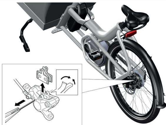
Imagen 37 : Cómo retirar las pastillas de freno para comprobar su desgaste
