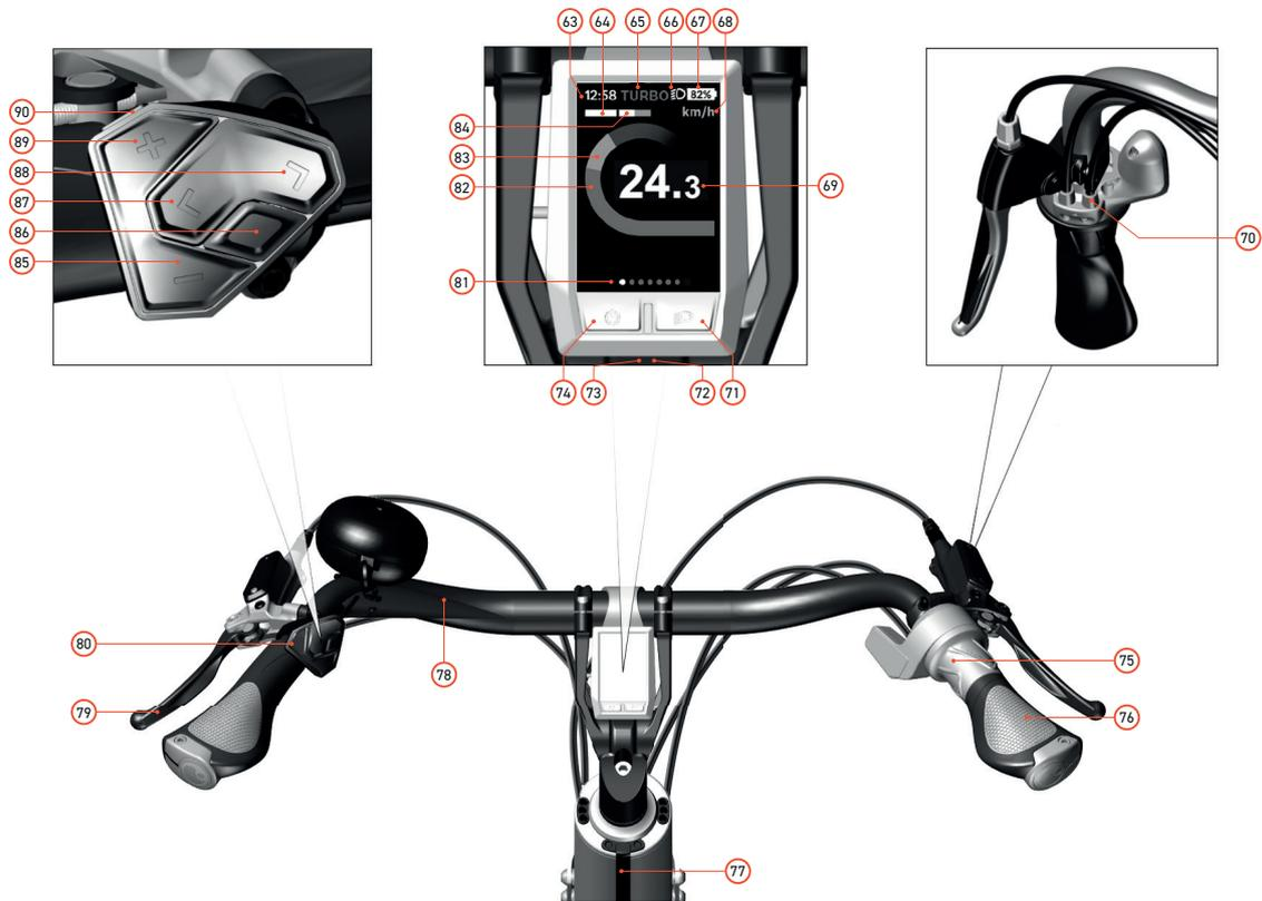
Imagem 3 : Guiador com visor Kiox e mudança de punho com indicador de velocidades
