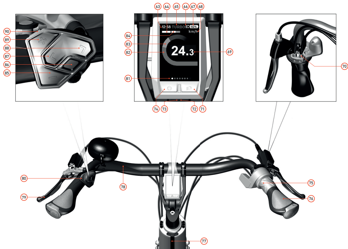
Image 3 : Guidon avec affichage Kiox et changement de vitesse avec indicateur de vitesse
