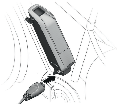
Abbildung 28 : Einstecken des Ladegerätsteckers in die Ladebuchse am unteren Teil der Akkualterung
