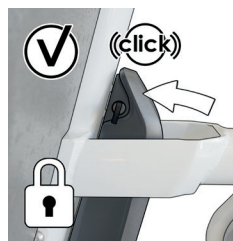
Afbeelding 18: Terugmelding juist geplaatste accu
