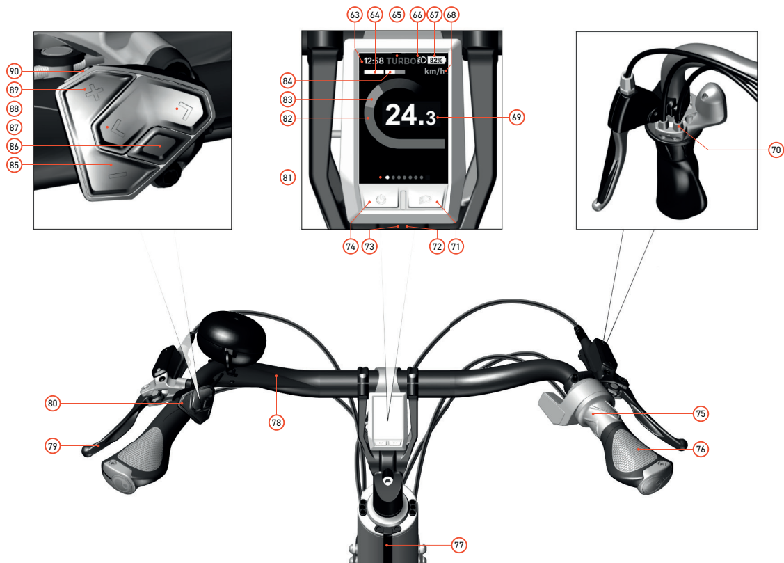
Afbeelding 3: Stuur met Kiox-display en versnellingshendel met versnellingsindicator
