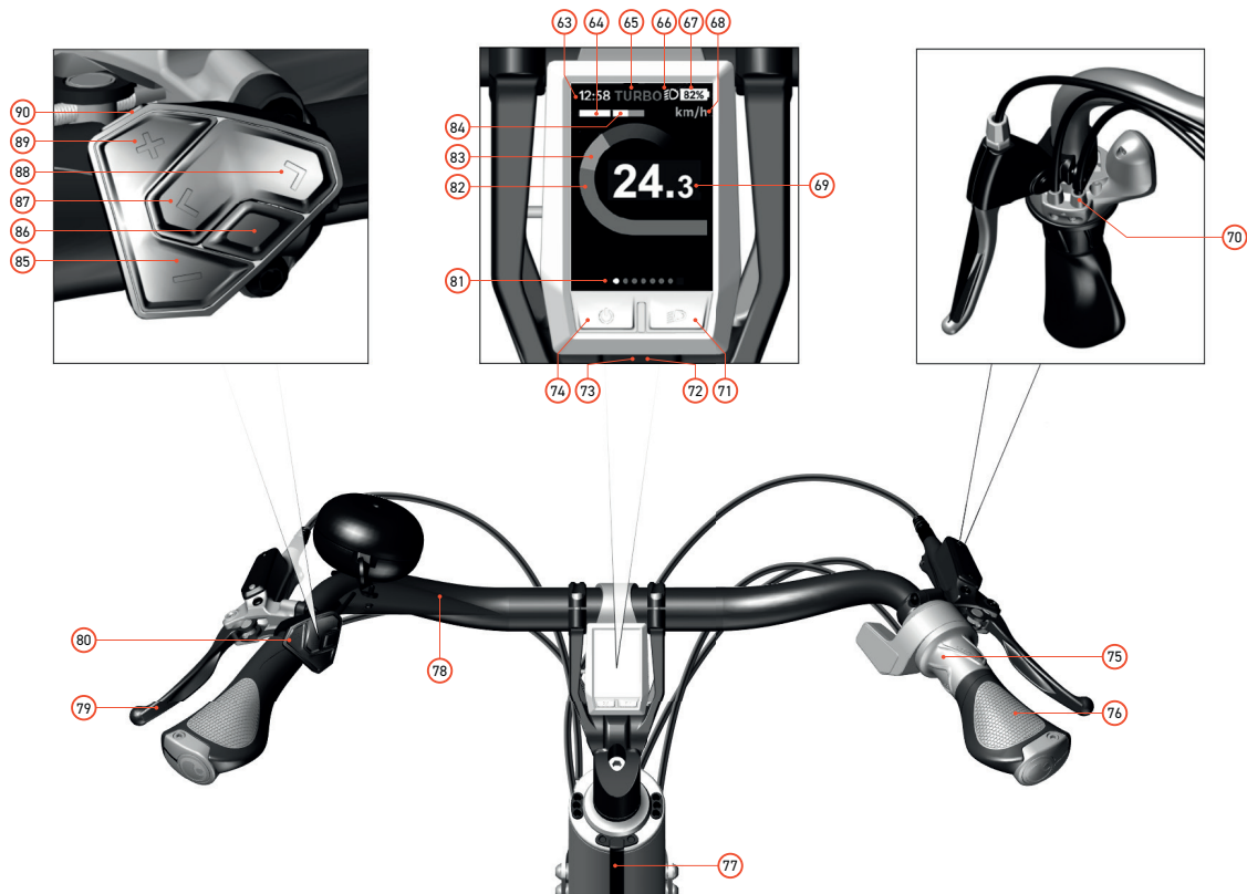
Abbildung 3 : Lenker mit Kiox-Display und Griffschalter mit Ganganzeige
